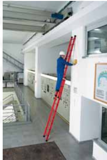
Bild 45: Sicherer Stand auf der Anlege-Schiebeleiter
