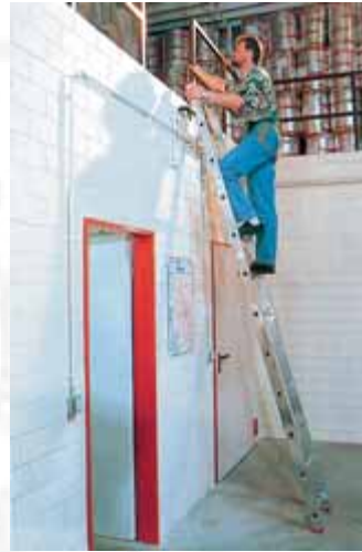
Bild 41: Eingehakte Anlegeleiter zum Übersteigen auf erhöhte Flächen mit Geländer als Haltemöglichkeit
